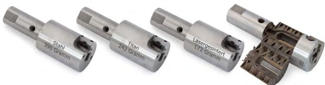
Abb. 7: Massenreduktion einer MAPAL-Außenreibahle von 390 g auf 172 g durch speziell entwickelte Rippenstruktur im Inneren des Werkzeugs.
